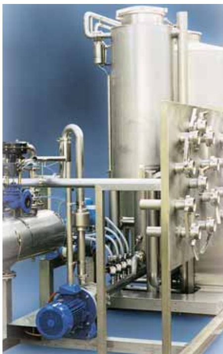
Exemple de centrale NEP (nettoyage en place) présentée dans le stage 900
